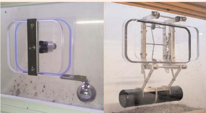
*Automatische Hochwasserschutzfenster mit Schwimmersteuerung*
